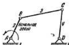
Рис. 3.5. Схема механизма, образованного присоединением группы звеньев 3 и 4 к начальному звеню 2 к стойке I
