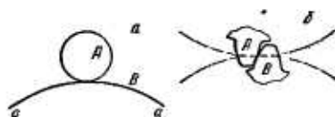
Рис. 1.16. Изображения высшей пары: а) пара с круглым роликом А и криволинейным профилем В; б) пара в виде двух касающихся криволинейных зубьев А и В
