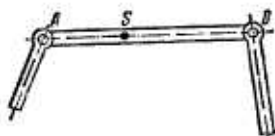
Рис. 12.8. К вопросу о размещении массы звена, центр масс которого расположен на прямой, проходящей через центры двух шарниров
