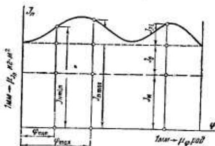
Рис. 19.7. Диаграмма полного приведенного момента инерции механизма, состоящего из момента инерции маховика, постоянного приведенного момента инерции звеньев и переменного приведенного момента инерции звеньев
