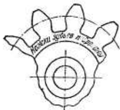
Рис. 22.29. Зубчатое колесо с подрезанными ножками зубьев
